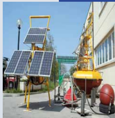
Figur 2 Övervakningsboj med solpaneler för energiförsörjning, flytkroppar samt instrument som tar gasprover vid havsbotten.
