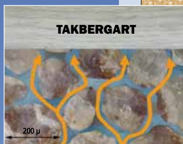
Figur 1 Injekterad koldioxid, som är lättare än vatten, stiger uppåt och stoppas av överliggande täta berggrundslager.
