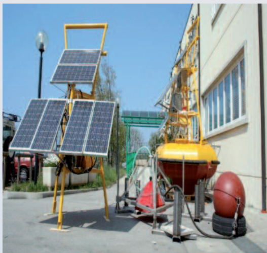
Slika 2 Boja za opazovanje, ki se energijsko napaja s sončnimi celicami, služi za vzorčevanje plina na morskem dnu.
