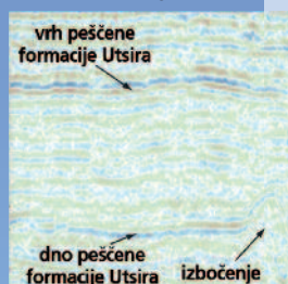
Slika 1 Seizmične meritve za spremljanje oblaka CO 2 v pilotskem projektu Sleipner pred začetkom vtiskavanja (leta 1996) in po vtiskavanju (3 oziroma 5 let kasneje).
