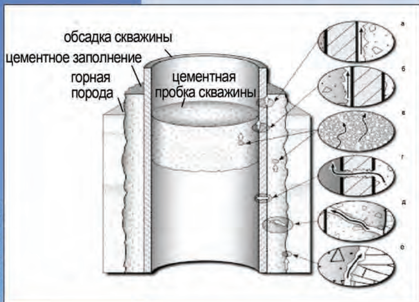
Рисунок 1 Возможные пути для CO 2 в скважине. Выход через измененный материал (в, г, д) или вдоль границ раздела (а, б, е).
