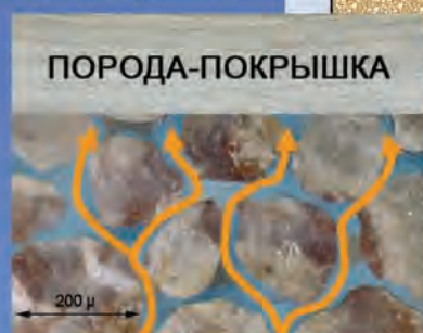
Рисунок 1 Закачанное CO 2 , которое легче воды, как правило поднимается и останавливается перекрывающими непроницаемыми породами.
