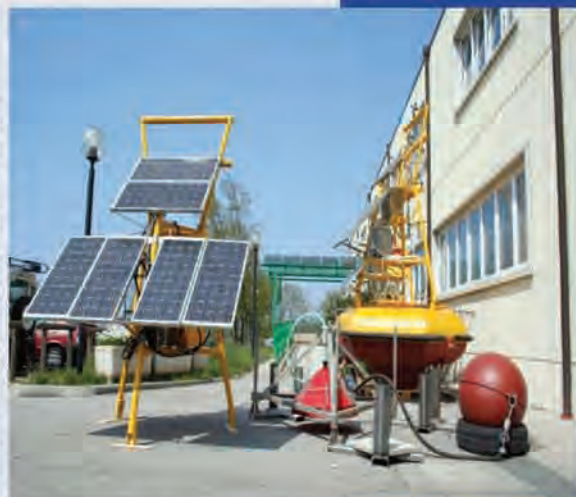
Рисунок 2 Буй для мониторинга с энергоснабжающими солнечными батареями, плот и устройство для взятия образцов газа со дна моря.
