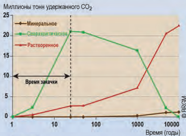
Рисунок 3 Развитие \text{CO}_2 в его различных формах в коллекторе Слейпнер согласно моделированию потока. \text{CO}_2 удерживается в сверхкритическом состоянии механизмами 1 и 2, в растворенном состоянии – механизмом 3, и в минеральной форме механизмом 4.
