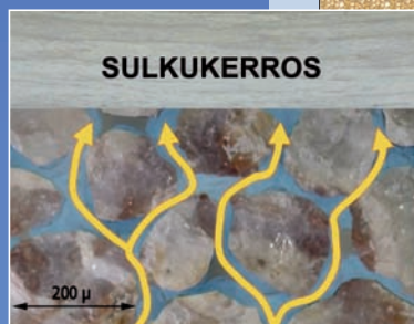
Kuva 1 Injektoitu vettä kevyempi CO 2 pyrkii nousemaan ylöspäin mutta pysähtyy päällä sijaitseviin läpäisemättömiin kerroksiin.
