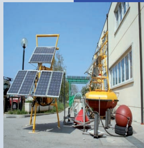
Kuva 2 Aurinkopaneeleista virtansa saava kelluva tarkkailupolju, johon kuuluu kaasua meren pohjasta keräävä laite.
