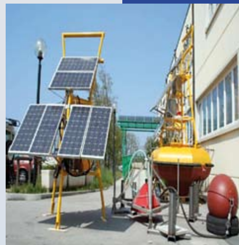
Obrázek 2 Monitorovací bój se solárními panely pro zajištění energie, plováky a zařízení pro vzorkování plynu na mořském dně.
