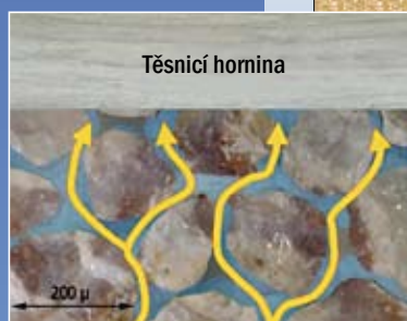
Obrázek 1 Injektovaný CO 2 , který je lehčí než voda, má tendenci stoupat vzhůru a je zastaven až nadložními nepropustnými horninami.
