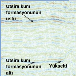
Şekil 1 Sleipner pilot sahasında enjeksiyon öncesinde (1996'da başladı) ve sonrasında (yaklaşık 3-5 yıl sonra) CO 2 yayılımını* izlemek için sismik görüntüleme.
