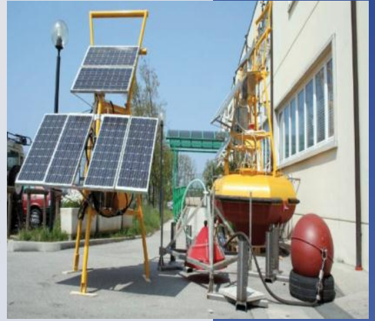
Şekil 2 Enerji temini için güneş panelleri olan, deniz yüzeyi ve deniz dibinden gaz örneği alan izleme cihazı
