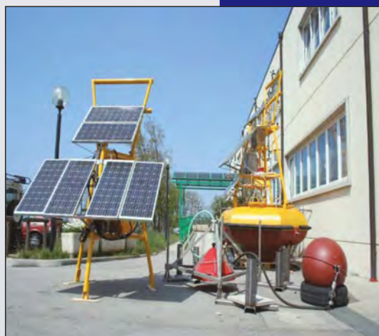
2.attēls. Monitoringa boja ar saules bateriju paneļiem energoapgādei, peldoša lērīce gāzes paraugošānai jūras gultnē.
