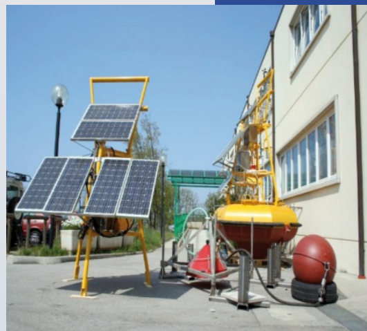
Joonis 2 Päikesepatareidest toituv seirepoi, ujukid ja vahend gaasiproovide võtmiseks merepõhjust.
