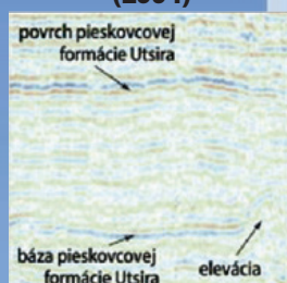
Obrázok 1. Seizmické záznamy monitorujúce mrak CO 2 * na úložisku Sleipner pred injeckážou (ktorá sa začala v r. 1996) a po injeckáži (o 3 a 5 rokov neskôr).
