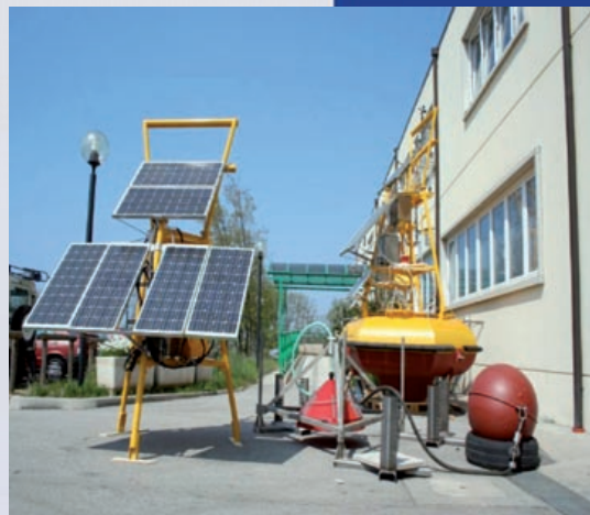
Obrázok 2. Monitorovacie bóje so solármi panelmi na zaistenie energie plavákmi a zariadením na vzorkovanie plynu na morskom dne.
