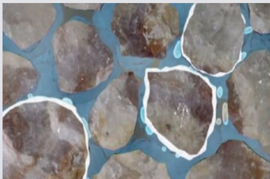
Obrázok 2. CO 2 migruje smerom dohora (svetlomodré bublinky), rozpúšťa zrná hornín a reaguje s nimi. To vedie k vyzrážaniu karbonátových minerálov na povrchu zŕn (biele lemy).
