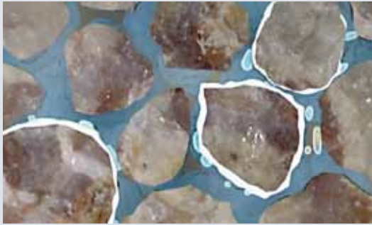
Фигура 2 Плътният \text{CO}_2 мигрира нагоре (светло-сините мехурчета), разтваряйки и реагирайки със зърната на скалата, което довежда до утаяване на карбонатни минерали по повърхността на зърната (в бяло).
