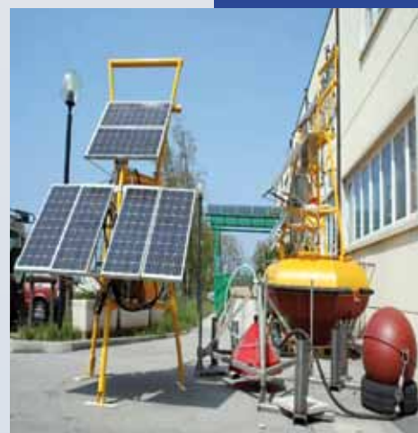
Фигура 2 Мониторингова шамандура със соларни панели за енергийно обезпечаване, лодка и устройство за взимане на газови проби от морското дъно.
