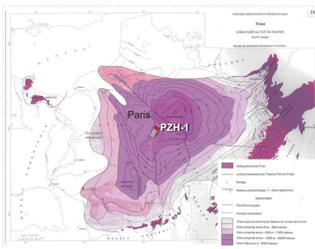
Fig. 2 Structure of the top of the Keuper formation and PZH-001 well bore (BRGM, 1980. Synthèse Géologique du bassin de Paris)
