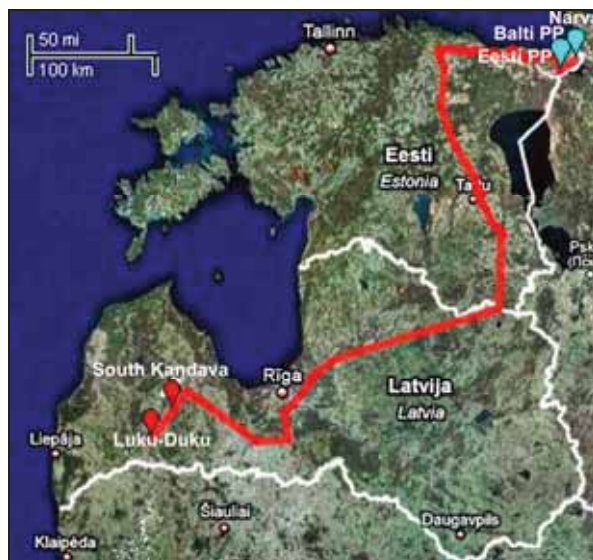
Joonis 2. Eesti–Läti stsenaarium. Eesti ja Balti Elektriijaamad ning ladustamiskohad on märgitud pirnukujuliste sümbolitega. Ette pandavad CO 2 torustikud (piki olemasolevat maagaasitorustikku) on näidatud laia joonega.
